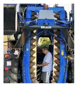
été disposés avec précision pour permettre à la machine de les franchir. Elle progresse rapidement le long de chaque rangée, faisant fortement vibrer les vignes. Les branches et les feuilles tremblent à au moins 30 pieds de la machine. Les vibrations secouent les grappes de raisin, qui sont soulevées sur un tapis roulant et acheminées vers un bac. Lorsque le bac est plein, les raisins sont déversés dans un camion qui les attend pour les acheminer à la établissement vinicole.
